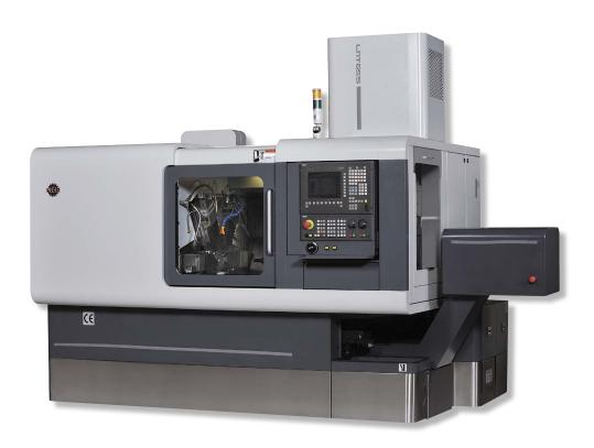
LICO ist einer der führenden Maschinenhersteller Taiwans. Mit der LNT-Serie präsentiert LICO einen neuen Stangendrehautomat. LNT ist ein automatisches Mehrschlitten-Drehzentrum, welches hohe Produktivität gewährleistet und die Vorzüge nockengesteuerter Drehautomaten mit modernster CNC-Mehrachsentechnik verbindet.
